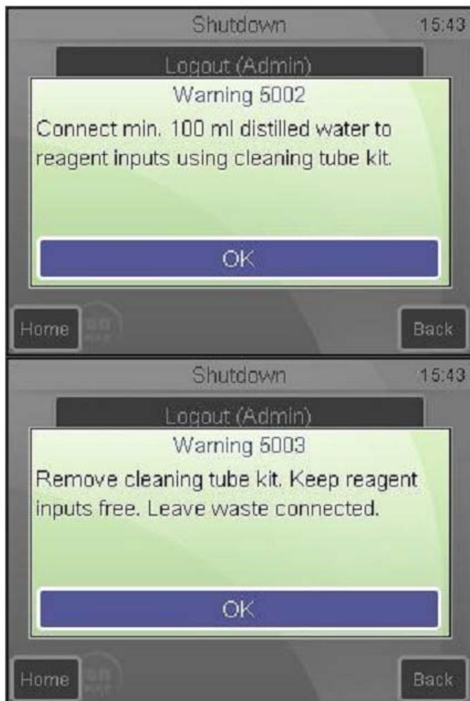
Затем следует подсоединить трубы очистительного комплекта к разъемам реагентов, опустив свободные концы в емкость, наполненную минимум 100мл дистиллированной воды.
