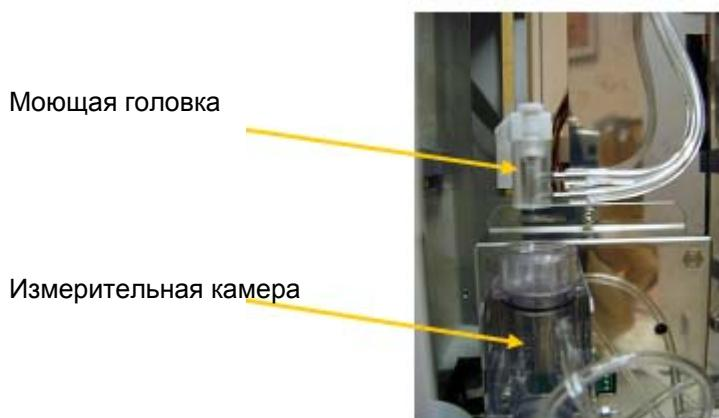
Рис.12. Измерительный блок.
